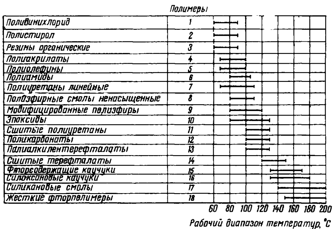
Рис. 65. Диапазон рабочих температур ряда полимеров [130]
